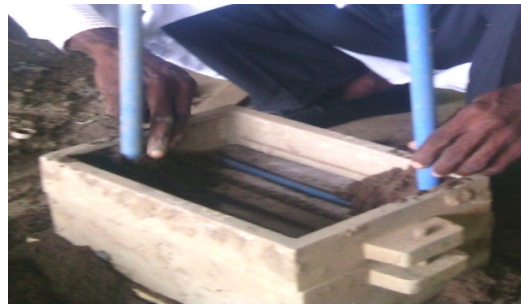
(d) Placing of cope over drag.
