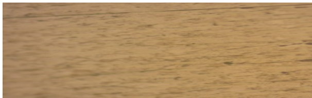
Fig. 6(d) Dry weld (200°C PWHT) X200
