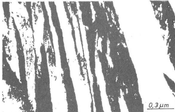
Sl.7 Mikrostruktura metalne osnove austenitizirane na 950°C i izotermno transformisane na 300°C/1h (TEM) Fig.7 Austempered matrix at 300°C/1h (TEM)
