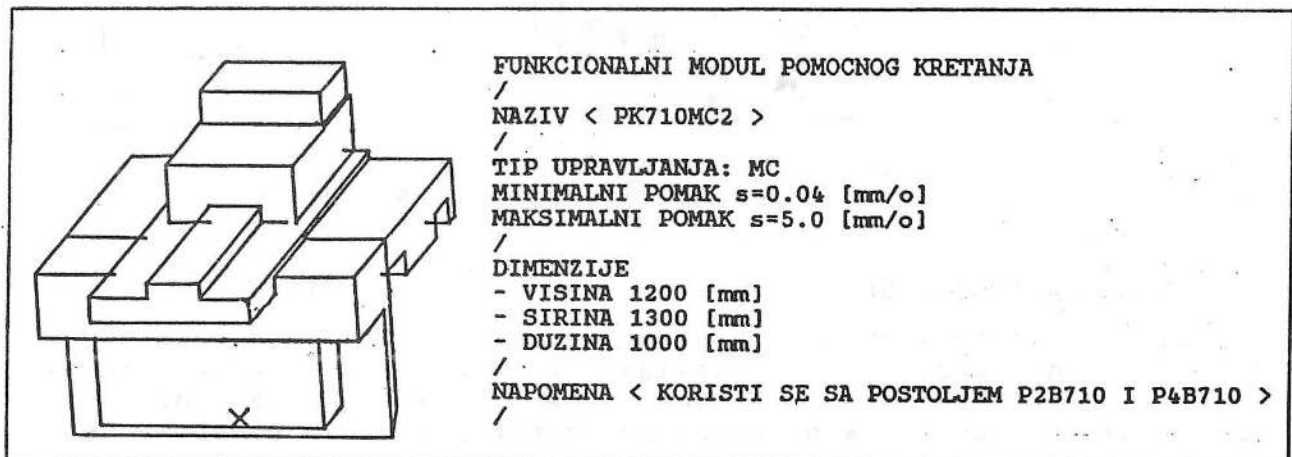
Sl.7 Funkcionalni modul pomoćnog kretanja Fig.7 Functional module of the feed drive
